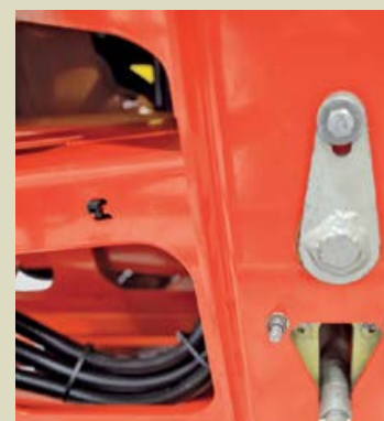
Hidraulični sigurnosni sistem po principu klatna
