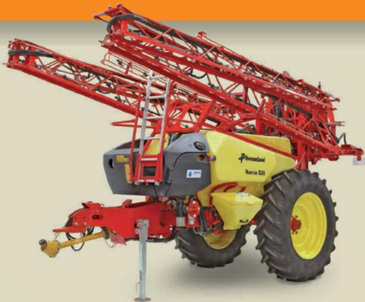
Ikarus S28 sa horizontalnom sklopivom čeličnom granom prskalice HSS od 27m
