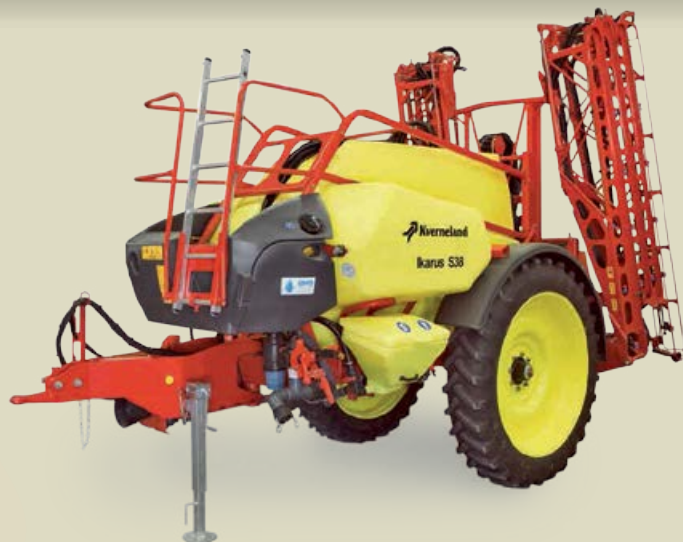
Ikarus S38 sa vertikalno sklopivom čeličnom granom prskalice HC od 24m
