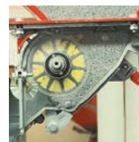
Podešavanje za finije seme sa rotirajućom četkicom
