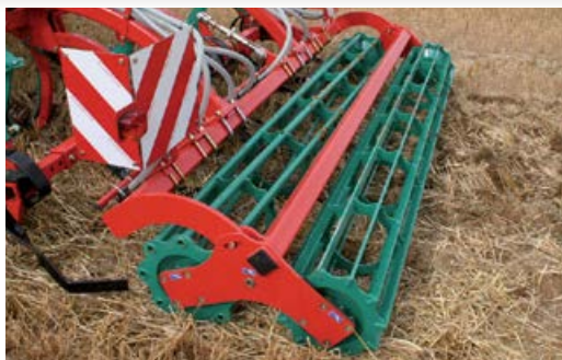
Dupli kavezasti valjak ø 400mm, 160kg/m (cevasti/letvasti)
