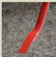
"C" motičice sa standardnim raonim vrhom obrtnog pluga.
