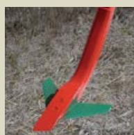
Standardni raoni vrh u kombinaciji sa krilcima raspona 32cm za plitku obradu.
