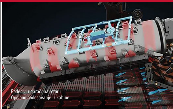
Podesivost udarača omogućava operateru optimizaciju izvršavanja i separacije.
